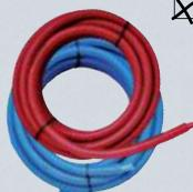
Peu sensible au calcaire et à la corrosion, le **PER** (Polyéthylène Réticulé) est une solution économique pour une pose encastrée (dalle ou maçonnerie) ou coffrée. Sans soudure, il doit être entouré d'une gaine de protection.
