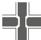
**Le double entaille :** les arrêtes des lames sont arrondies pour faciliter l'emboîtement et assurer l'étanchéité de l'ensemble.
