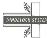
**Le Windblock System® :** des encoches d'emboîtement sont réalisées au-dessus et en dessous des madriers afin que chacun soit emboîté et bloqué dans les madriers supérieurs et inférieurs.
