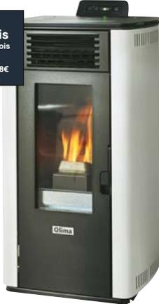
⇒ En acier et fonte. Rendement 92,7%. Puissance de 2,65 à 7,45 kW. Autonomie jusqu'à 22h. Capacité du réservoir 13 kg. Programmable. l. 47 x P. 47,6 x H. 89,9 cm. Garantie 2 ans. Réf. 8713508776538.
