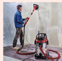
Prise d'asservissement : permet de brancher un outil électroportatif
