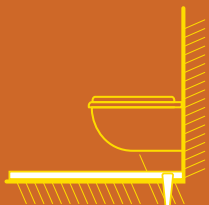
Bâti autoportant renforcé : fixation sol (possibilité de pose en îlot)
